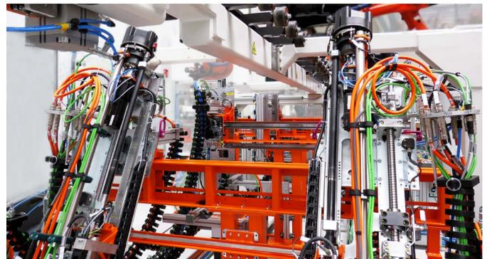
Schraubstation x-bolt mit Schraubsystem x-gun
